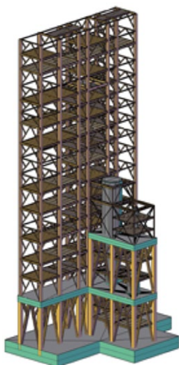
Рисунок 5 — Расчетные схемы блока №1 нефтехимического перерабатывающего завода, высотой 76 м
