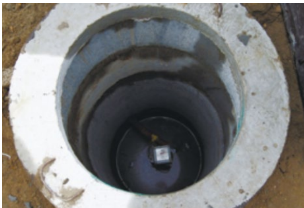
Рисунок 4 — Общий вид колодца для грунтового датчика ускорений
