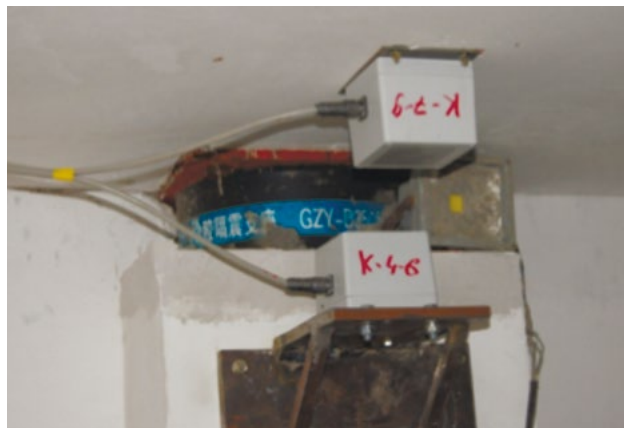
Рисунок 5 — Общий вид датчиков ускорений в уровне «0», «+1»
