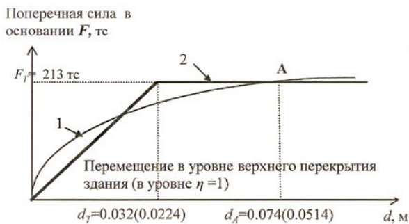
Рисунок 1 — а) – Экспериментальная зависимость «поперечная сила в основании – перемещение в уровне покрытия (в уровне η=1)»: 1 – экстраполяция экспериментальной зависимости на область больших перемещений; 2 – аппроксимация экспериментальной зависимости идеализированной билинейной диаграммой. б) – Определение нелинейного перемещения 9-этажной блок-секции серии 111 (на примере землетрясения с интенсивностью 7 баллов).
