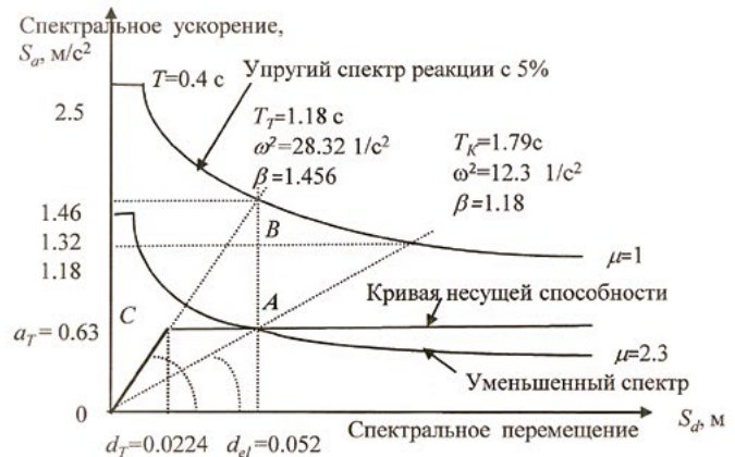
Рисунок 1 — а) – Экспериментальная зависимость «поперечная сила в основании – перемещение в уровне покрытия (в уровне η=1)»: 1 – экстраполяция экспериментальной зависимости на область больших перемещений; 2 – аппроксимация экспериментальной зависимости идеализированной билинейной диаграммой. б) – Определение нелинейного перемещения 9-этажной блок-секции серии 111 (на примере землетрясения с интенсивностью 7 баллов).
