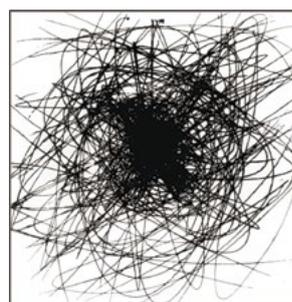
**Рисунок 26** — Запись маятника с периодом 0.8 сек многомаятникового сейсмометра ИГИС, полученная в Ленинакане
